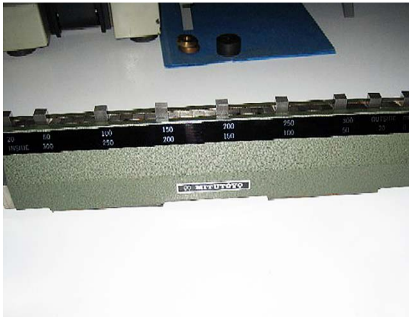
Voor interne controles blijkt de 'stappeneindmaat' nog steeds een probaat meetmiddel te zijn.
