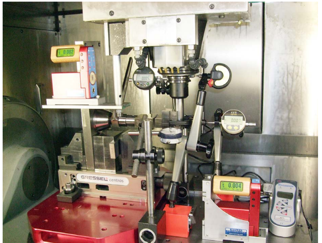
Voorbeeld van een meetopstelling met vijzel, meetklokken en elektronische waterpassen.
